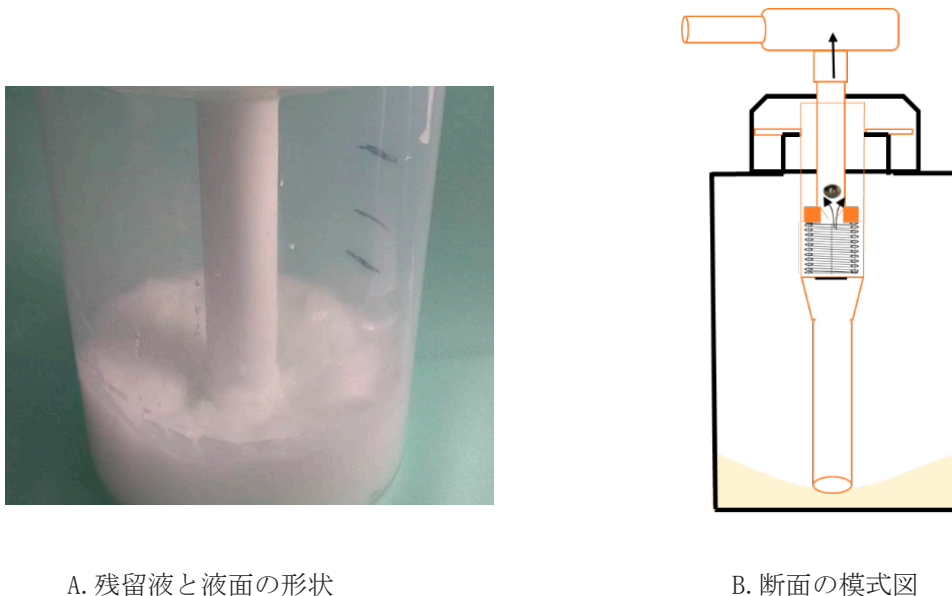
図3 吐出しなくなった状態
